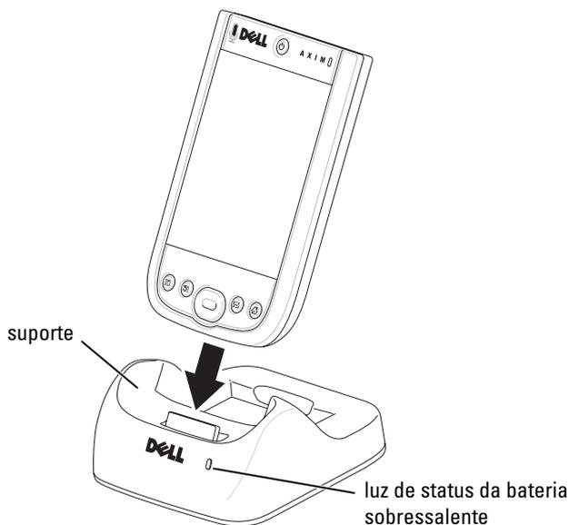
Quando o dispositivo estiver acoplado no suporte, o botão liga/desliga do suporte se acende e o ícone de status da conexão aparece na barra de comando (consulte a página 65).
